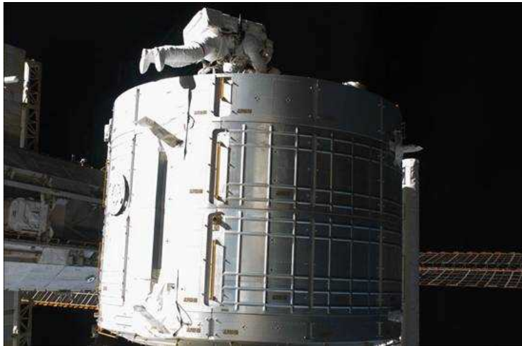
図 1-5 船内保管室(外観)
