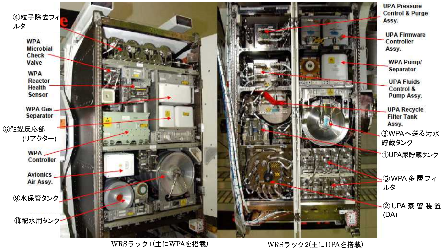
図4.1-1 WRS1, 2ラックの機器構成と水処理の主な流れ
