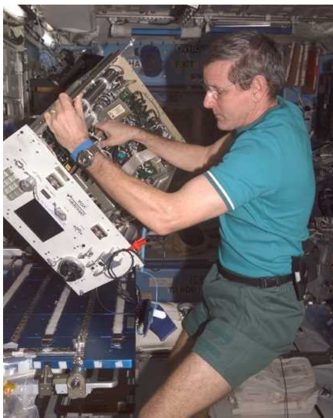
図3.4-5 故障した装置(揮発性有機物分析器(VOA))の修理
