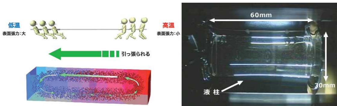
図4.1.1-3 マランゴニ対流の原理(左)と軌道上実験で作られた60mmの液柱(右) [RYUTAIラックの流体物理実験装置を使用]
