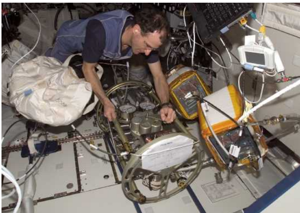
図3.4-4 デスティニー内での熱制御系の冷却水の補充作業
