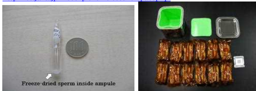
図4.1.1-7 宇宙実験でマウスの精子を保存するのに使用するアンプル。アンプルは右の写真のようにカプトンテープで保護してケースに収納します。(HTV4で運搬)
