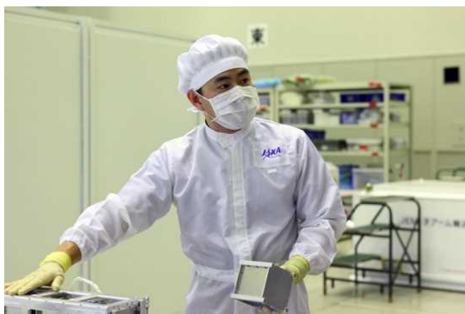
図4.1.1-23 CubeSat(星出宇宙飛行士が手に持っているのが1UサイズのCubeSat)
