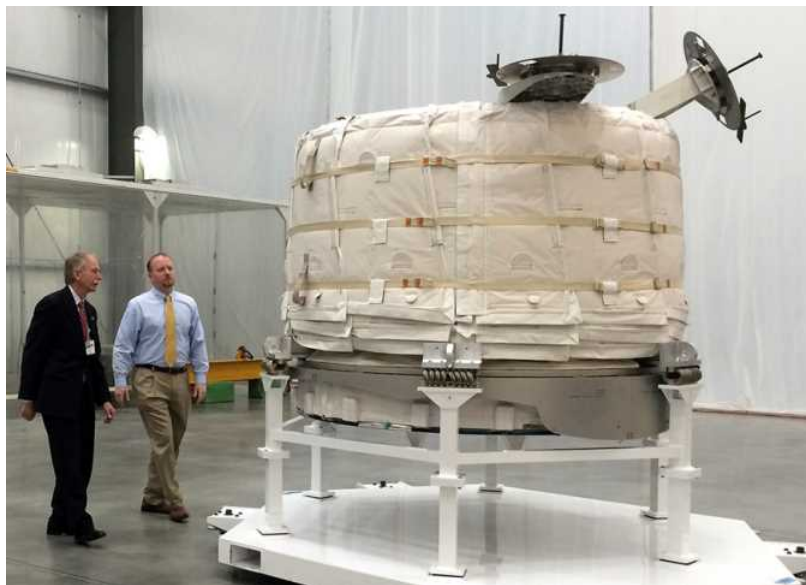
図 A6-7 2015年3月12日に初公開されたBEAMの実機(打上げ時の収納状態)(NASA)
