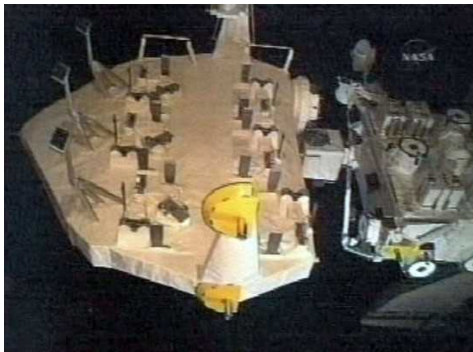
図 1-10 船外パレット外観 (船外実験プラットフォームから取り外されたところ)
