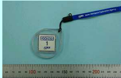
図4.1.1-17 JAXAが開発したCrewPADLES(受動式線量計) これを常に携帯します
