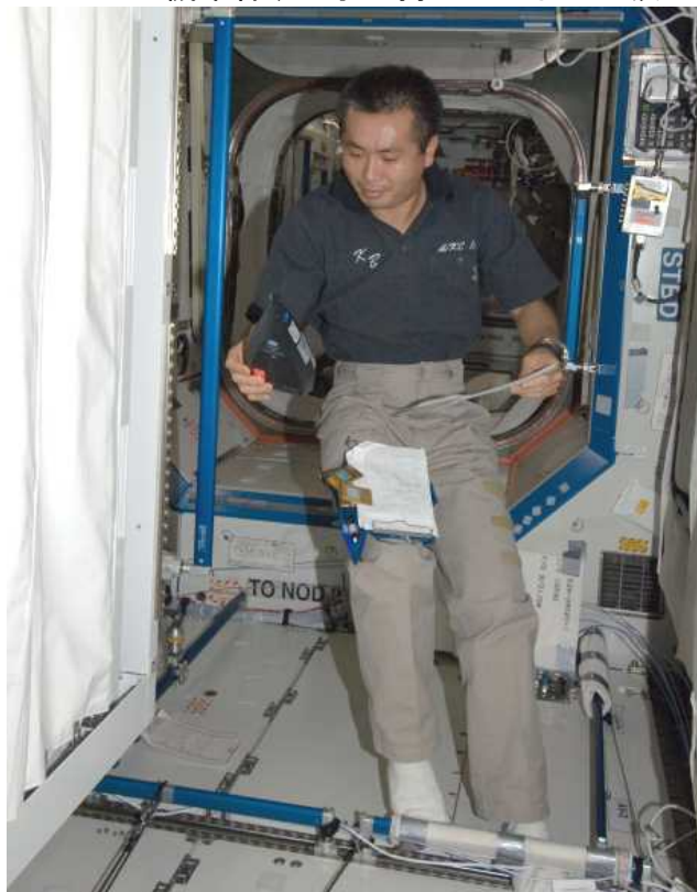
図4.2-4 ノード3内で騒音の計測を行う若田宇宙飛行士(右手に持っているのが騒音計)
