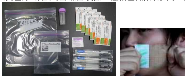
図4.1.1-14 Mycoサンプリングキット(右)、左はサンプリングシートを使って頬から皮膚の試料採取を行うイメージ
