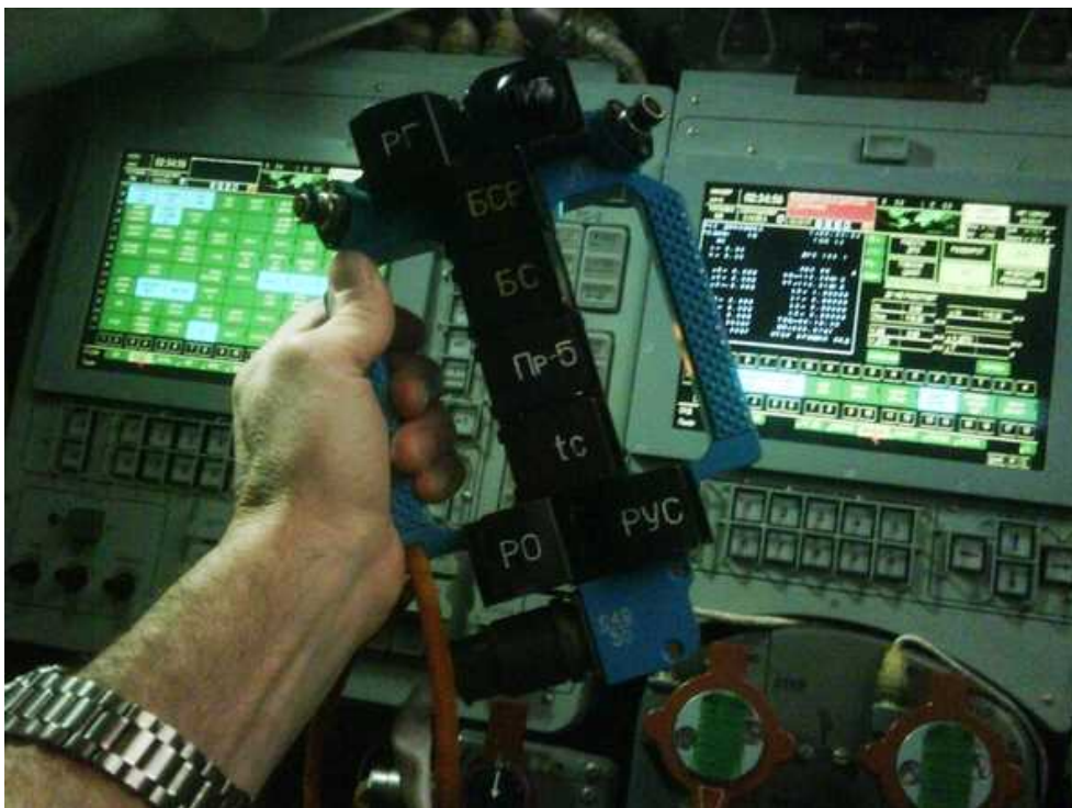
図3.5-6 手動揚力コントロールモードでのソユーズ宇宙船帰還時に使う操縦装置 (カナダ人宇宙飛行士Chris HadfieldのTwitterより)
