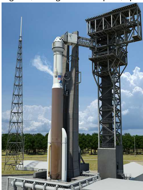
図 A6-2 アトラス V ロケットに CST-100 を搭載したイメージ図(NASA)
