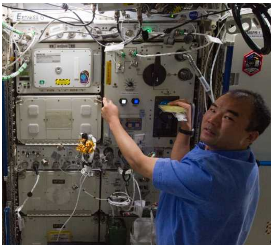
図3.2-4 飲料水供給装置を使う野口宇宙飛行士 (上はロシアの機器、下は米国の機器)
