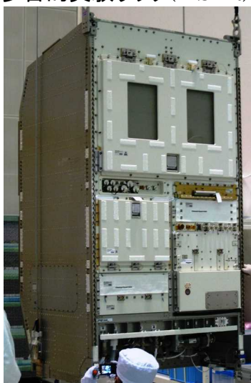
図 4.2.4-2 多目的実験ラックの写真(打上げ前)
