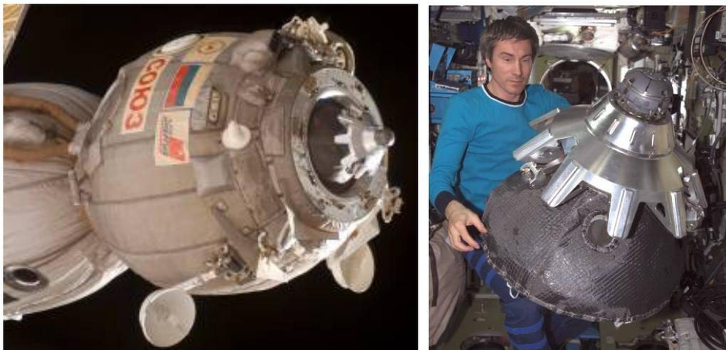
図2.1.6-2 ソユーズ宇宙船のドッキング機構
