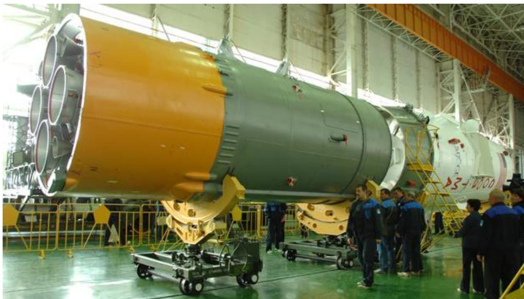
図2.1.8-4 第3段ロケットとソユーズ宇宙船を収納したペイロードシュラウドの結合作業
