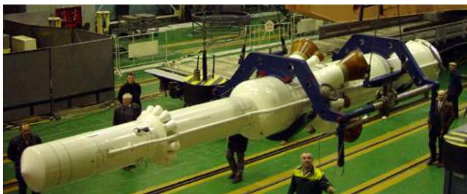
図2.1.6-4 ソユーズロケット先端に装着される緊急脱出用ロケット(RSCエネルギー社)
