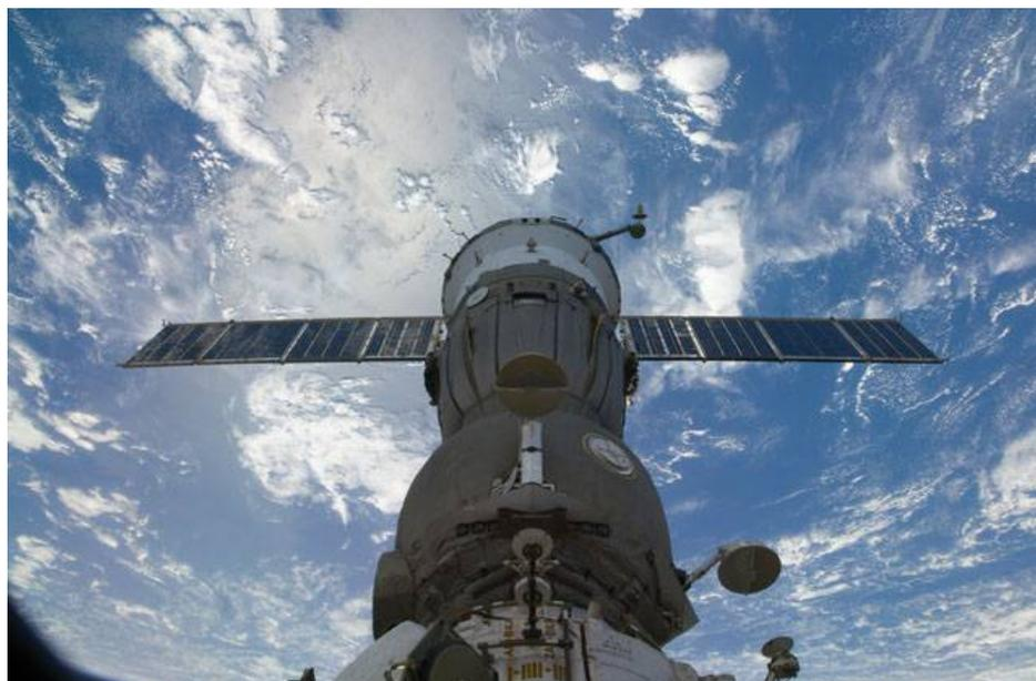
図2.1.7-4 ピアースのドッキングポートにドッキングしたソユーズ宇宙船
