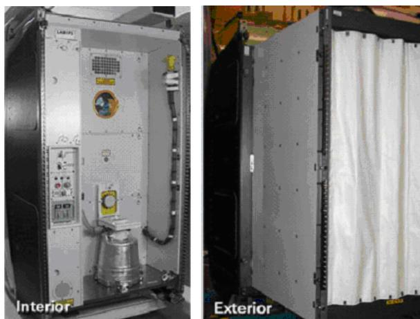
※左の写真はWHC内部の状態。軌道上では、右の写真のようにプライバシーカーテンを閉めて使用します。
