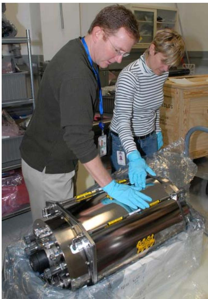
図4.4.1-4 STS-119で運ばれる交換用のDistillation Assembly(DA)
