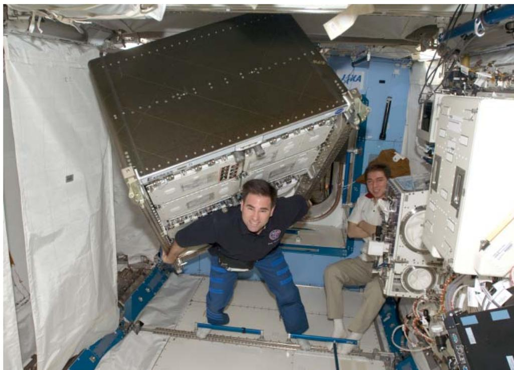
図3.3.4-13 「きぼう」内でのラックの搬入・設置作業(上・下)
