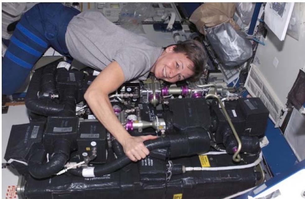
図3.3.4-3 米国の二酸化炭素除去装置(CDRA)の修理 (デスティニー内)
