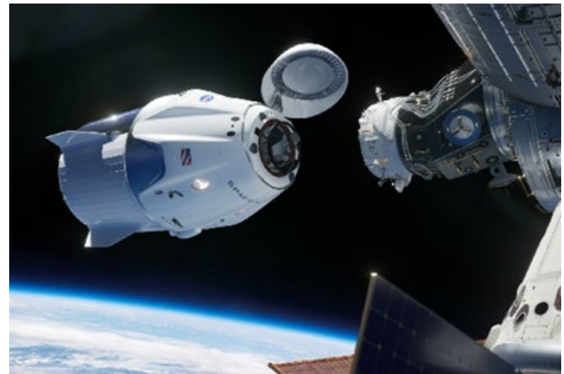
ドラゴン宇宙船がISSにドッキングするイメージ (NASA) (ISSの進行方向側のスペースシャトルがドッキングしていたPMA-2に、IDA(International Docking Adapter)というアダプタを設置しており、そこにドッキングする。IDAへのドッキングは今回が初めてとなる。)
