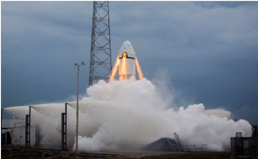
2015年に行われたPad Abort試験(SpaceX) (打ち上げ時に異常が発生した場合に、ロケットからカプセルを切り離して緊急帰還する。)
