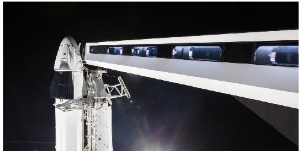
Demo-1を搭載したファルコン9ロケットを使ったクルー搭乗ブリッジとの結合試験 (SpaceX)
