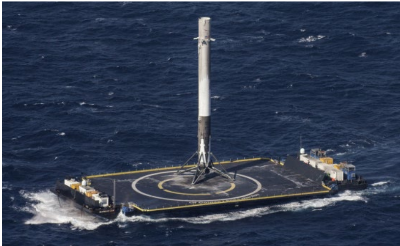
洋上の台船に帰還した1段ブースター (CRS-8) (SpaceX) http://www.spacex.com/news/2016/04/09/crs-8-launch-and-landing
