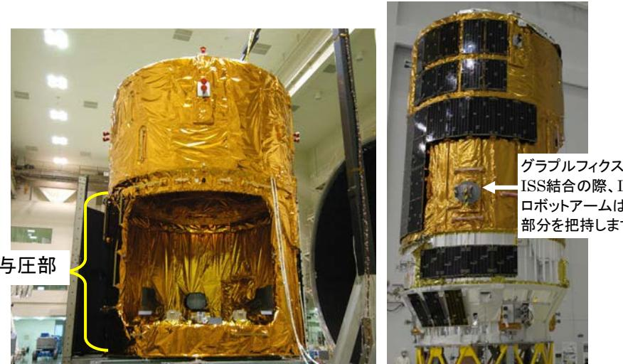
図A1.2-1 補給キャリア非与圧部(1号機)(左は曝露パレット搭載前)(JAXA)
