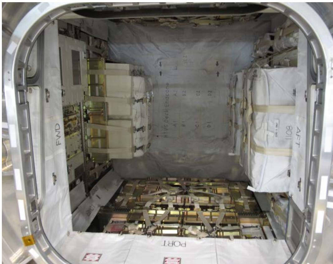
図A1.1-3 「こうのとり」5号機内部のラック配置 (JAXA)
