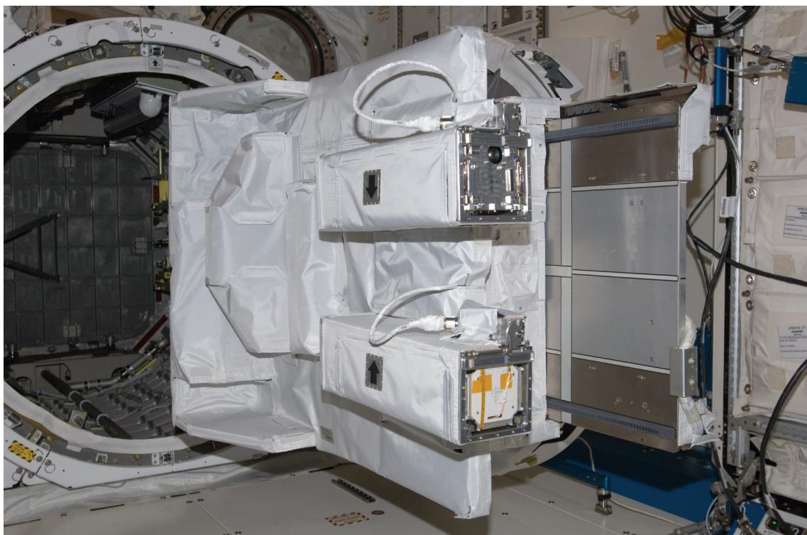
図5.1.1.3-7 小型衛星放出機構(J-SSOD)
