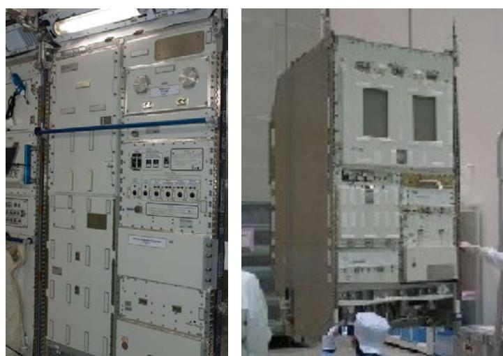
図A3-13 溫度勾配炉(GHF)ラック、多目的実験ラック(MSPR) (2号機で輸送)(JAXA)
