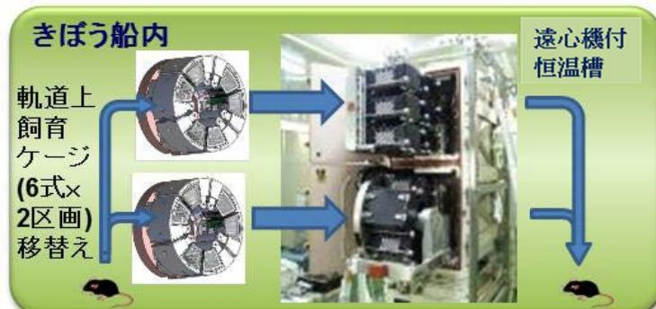
図5.1.1.3-2 軌道上の遠心機付恒温槽に取り付けて人工重力環境と微小重力環境で飼育 (JAXA)
