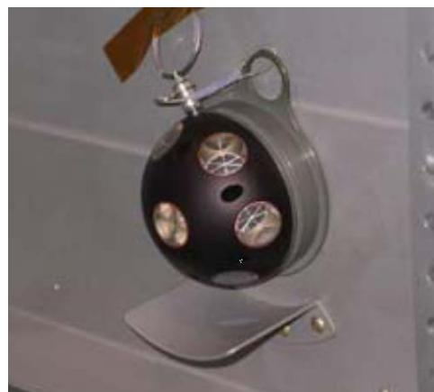
図A1.7-1 「きぼう」に設置された「こうのとり」用の反射器 (JAXA)
