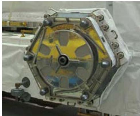
図A1.3-4 簡易型ペイロード側装置交換機構(HPIU) (JAXA)
