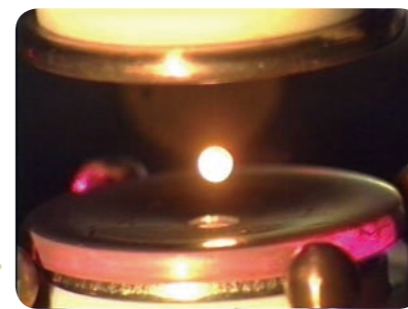
静電浮遊炉で高温の試料が浮遊している様子(地上実験)。高融点材料の熱物性を測る。
