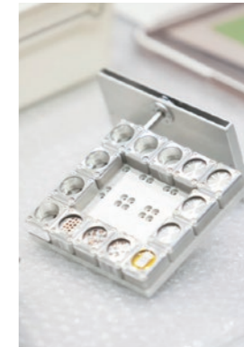
↑ ExHAMの実験試料が入ったアダプターの例。10cm角のアダプターの中に試料が並んでいる。 → 「きぼう」の小型衛星放出機構(J-SSOD)から放出された超小型衛星
