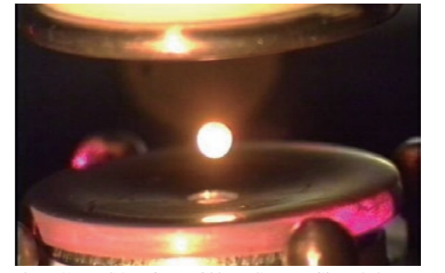
地上の静電浮遊炉で高温の試料が浮遊している様子。宇宙では、より帯電しにくい試料での成果が期待されている。
