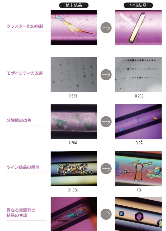
「きぼう」では、小さな結晶が多数集まってしまうクラスタ化が抑制されるなど、地上より品質の高い結晶を生成することができる。
