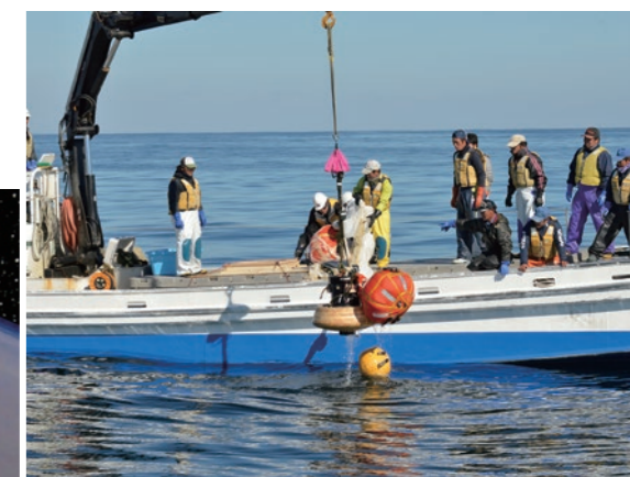
↑模擬小型回収カプセルを用いた高空落下試験を実施した。着水したカプセルを回収している様子。 ←「こうのとりのり」から放出される回収カプセルの想像図
