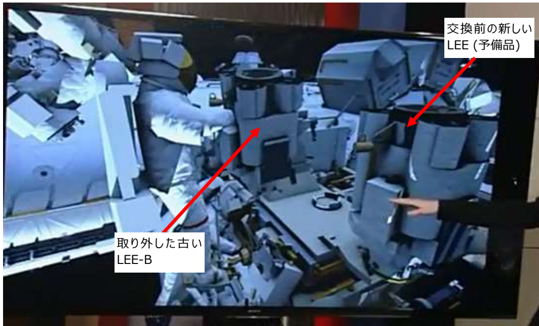
図10 ESP-2上でのLEEの交換作業イメージ (NASA TVより)
