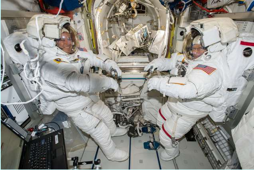
図23 EMUを着用した状態でのISLEプリブリーズ（写真奥が宇宙へ出るためのCrew Lock）
